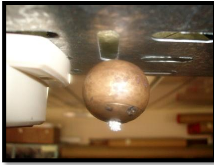
Figura 1: Fotografía del cuerpo utilizado en las mediciones, mientras era sostenido por el hilo, instante antes de comenzar la caída.
